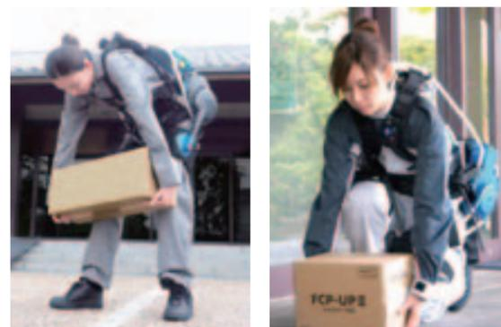
パワードスーツ試作機「AWN-02」(右)と「AWN-03」(左) 荷物持ち上げ時、持ち運び時と使用者の動きに追従してモードが切り替わる
