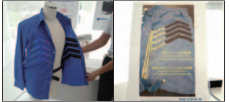
印刷配線（写真右）が施された衣服（写真左）。LED を付ければ、コンサートでの衣装など、エンターテインメントのツールとして使用可能。
