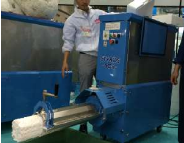
↑ 発砲スチロール減容機「スチロス」
