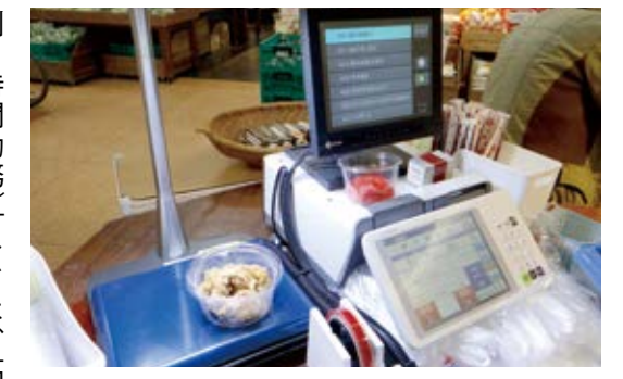
業務の平準化を目的としたAIを活用した総菜自動会計システム。自動的に商品を識別しレジに価格が反映される
