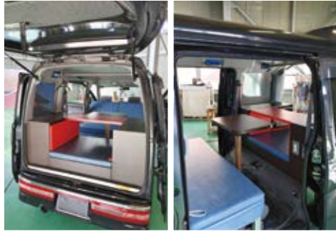
車両後部に事務スペースを内蔵し、リモートワークに対応した同社開発のオフィスカー
