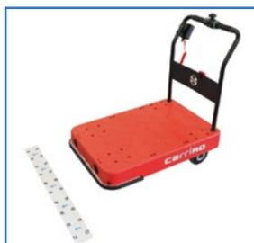
作業者に自動で追従する重量型運搬ロボット。360度ターンができるなど、小回りも利きます。複数台を連動させるカルガモモードもあり、倉庫や工場内の様々なシーンで活躍できます。
