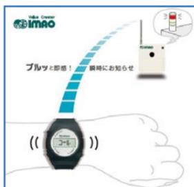
機械のトラブル発生、また担当者の呼び出しを腕時計型受信機に振動とメッセージでお知らせ。あなたに代わって機械を見張り、機械トラブルによる生産性の低下を防ぎます。
