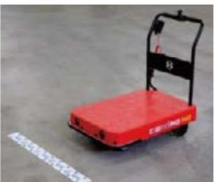
↑ロボット台車は、作業員を自動的に追従するほか、経路を指定すれば無人での移動・運搬も可能。
