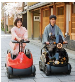
同社が開発した「RODEM」は、ロボット、モビリティ(乗り物)、車いすとしての役割を1台で果たす次世代型スマートモビリティ。テクノフェア2022の会場でも見学できます。
