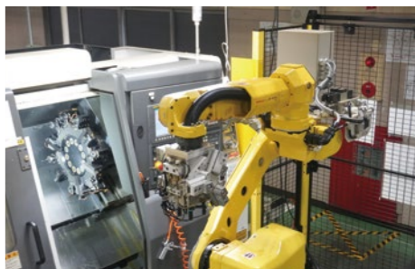
永平寺工場のNC旋盤の生産ラインに配備されている産業用ロボット。現時点で9機のロボットが稼働しており、作業員の負担が軽減されています。
