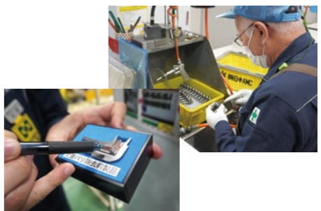
バリは継手の内側に発生するため、ペンライトで中を照らしながら、わずかでも出っ張りがないか確認し、除去しています。
