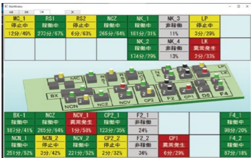
工場内に設置されたカメラで、生産ラインの稼働状況が事務所からでも一目瞭然に。グリーンが正常稼働、黄色がメンテナンス中、赤色が異常発生を示しています。
