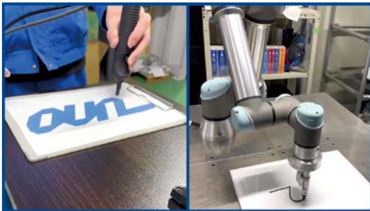
人の動き、力覚（左側）に合わせて動く協働ロボット（右側）
