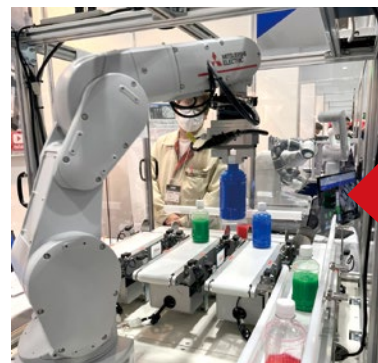
力覚センサー搭載ロボットアーム。重さが異なるボトルをアームが掴んだ際に重量を感知して各ラインに移動させます。
