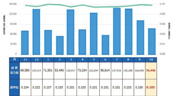
「Kobelink」を活用すれば、リアルタイムに消費電力量をグラフ化するため、消費量が増えた場合は「設備に異常があったのでは？」と推測することができます。
