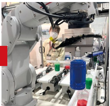
力覚センサー搭載ロボットアーム。重さが異なるボトルをアームが掴んだ際に重量を感知して各ラインに移動させます。
