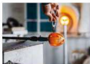
溶けたガラスに息を吹き込む
